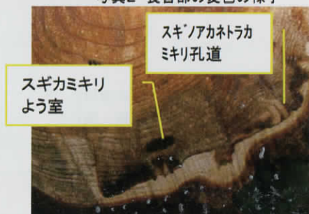
写真4 スギカミキリのような室とスギノアカネトラカミキリの孔道
