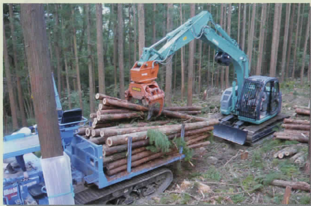
林内作業車（フォワーダ）とグラップルを併用し、木材の搬出をおこなう。
